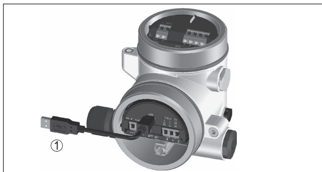
Рис. 26: Подключение ПК через USB к электронике Modbus
