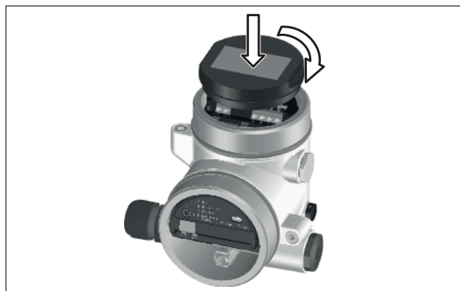
Рис. 9: Установка модуля индикации и настройки
