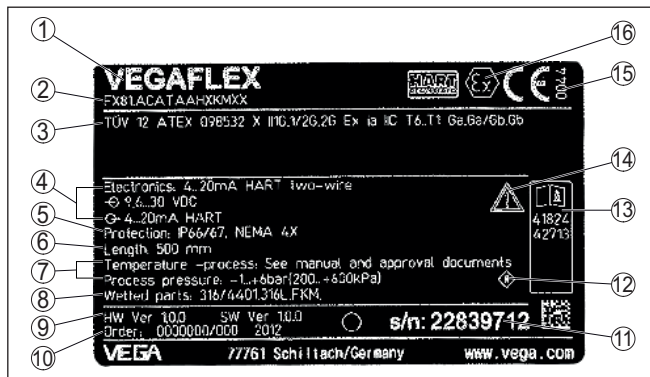
Рис. 1: Данные на типовом шильдике (пример)
