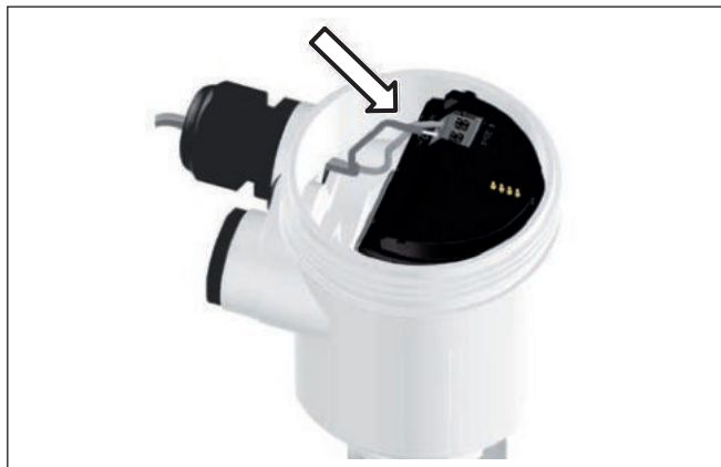
Рис. 3: Шаги подключения 5 и 6 - однокамерный корпус
