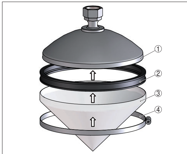
Рис. 10: Монтаж крышки антенны
