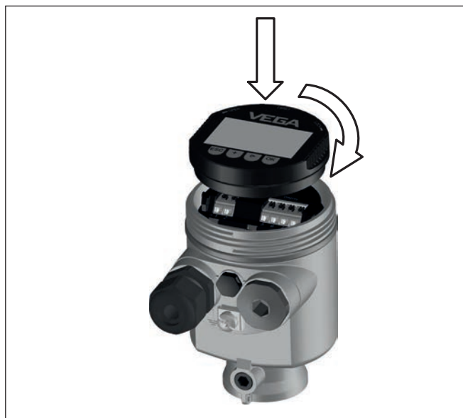
Рис. 4: Установка модуля индикации и настройки в отсеке электроники однокамерного корпуса
