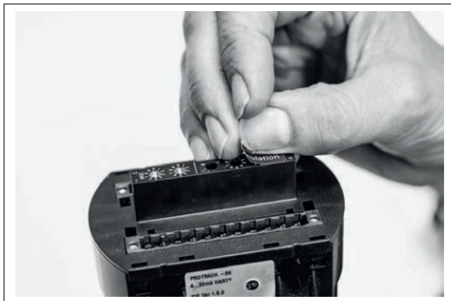
Рис. 2: Profibus PA - снятие покрывающей пленки с переключателей адреса
