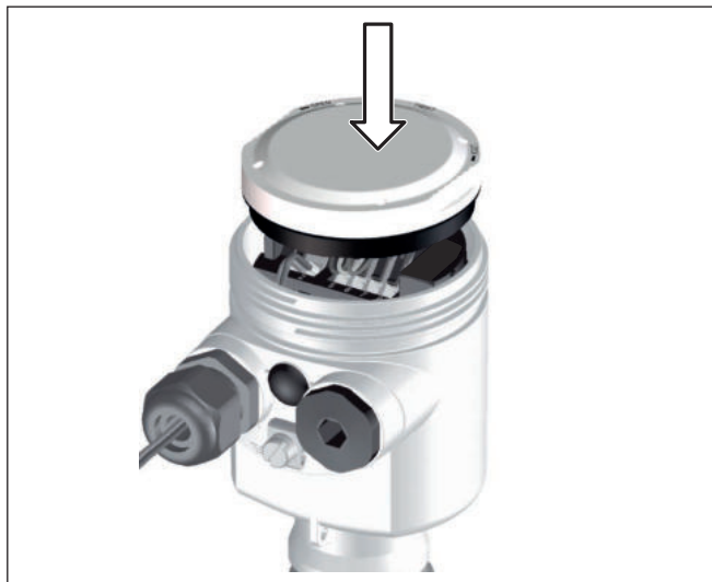
Рис. 3: Модуль индикации надеть на блок электроники
