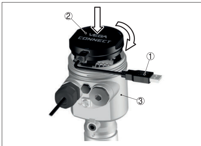
Рис. 40: Подключение ПК через интерфейсный адаптер прямо к датчику
