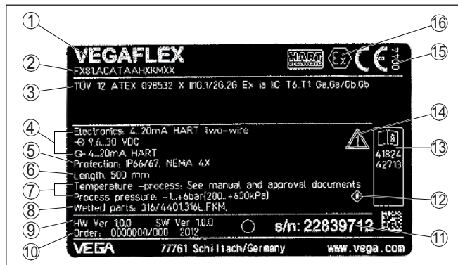
Рис. 1: Данные на типовом шильдике (пример)
