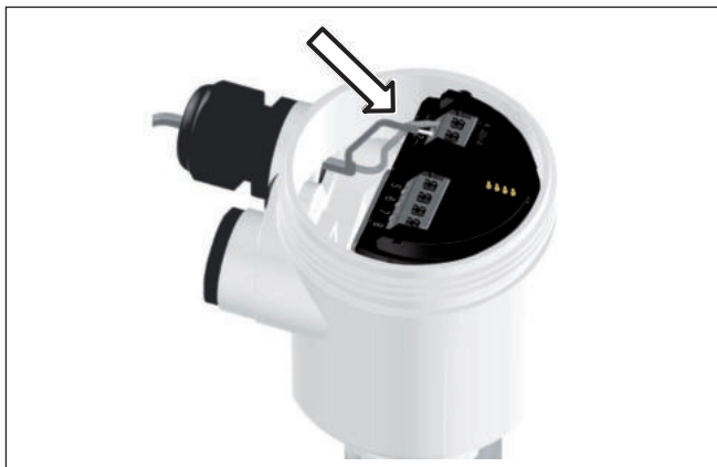
Рис. 6: Шаги подключения 5 и 6 - однокамерный корпус
