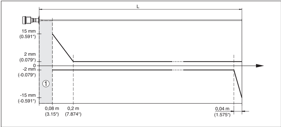
Рис. 49: Погрешность измерения VEGAFLEX 83 в стержневом исполнении (среда - вода)
