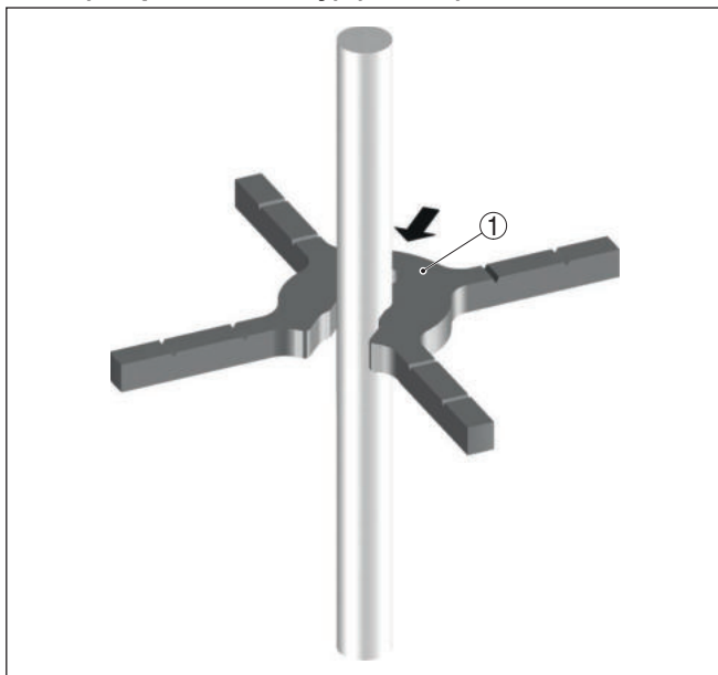
Рис. 9: Монтаж центрирующих звездочек из пластика (открытых сбоку)
