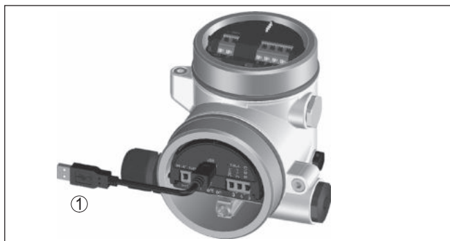
Рис. 35: Подключение ПК через USB к электронике Modbus 1 Кабель USB к ПК
