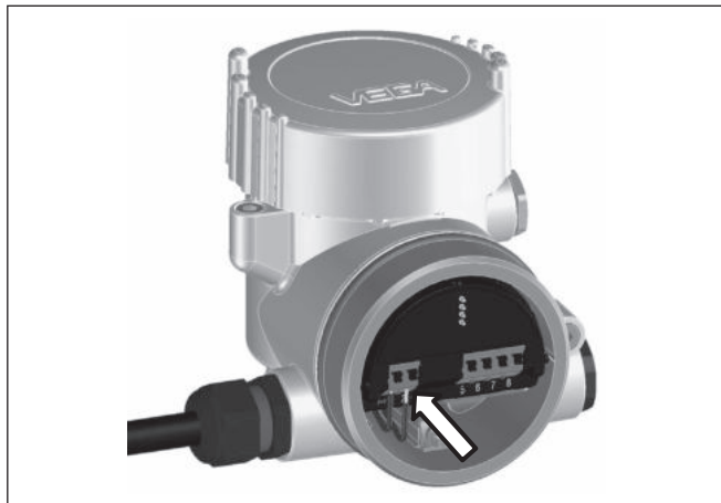
Рис. 6: Подключение: шаги 5 и 6
