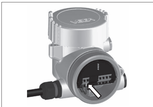
Рис. 23: Шаги подключения 5 и 6 - двухкамерный корпус
