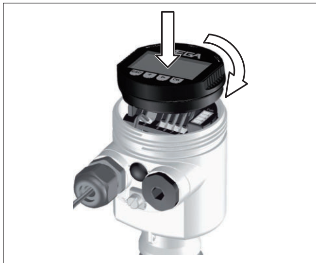
Рис. 6: Установка модуля индикации и настройки
