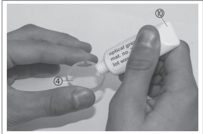
Рис. 10: Нанесение специальной смазки с одной стороны на оптическую прокладку
