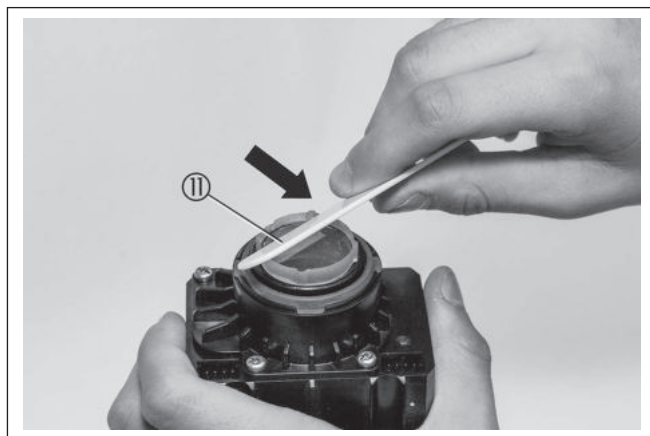
Рис. 15: Провести пластиковым шпателем по второй стороне оптической прокладки
