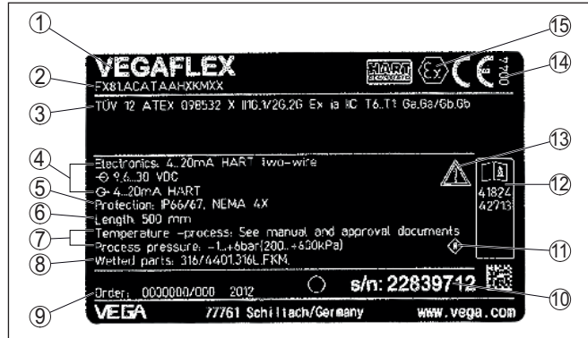
Рис. 1: Данные на типовом шильдике (пример)
