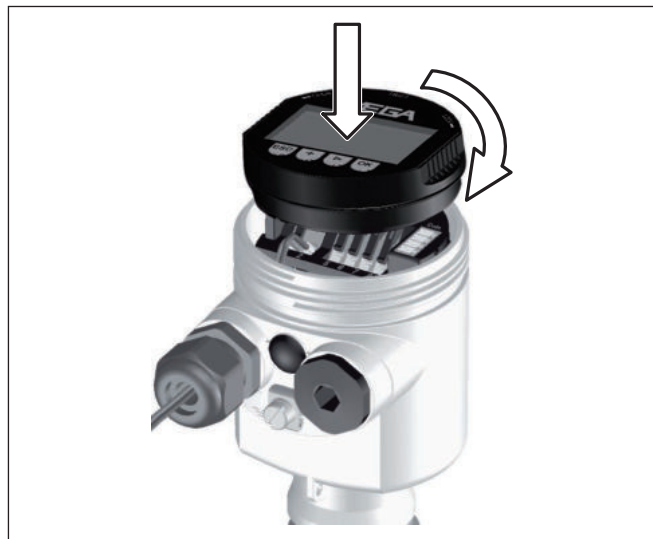
Рис. 23: Установка модуля индикации и настройки
