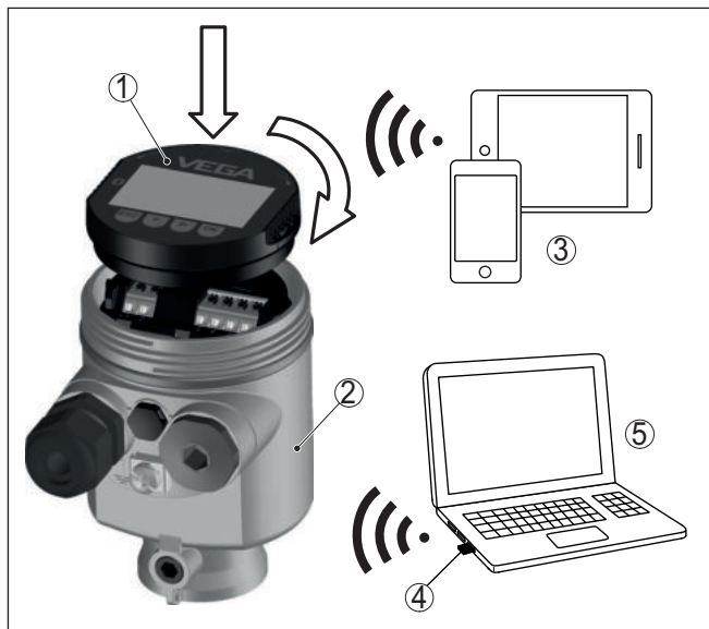
Рис. 2: Беспроводное соединение со стандартными устройствами для настройки
