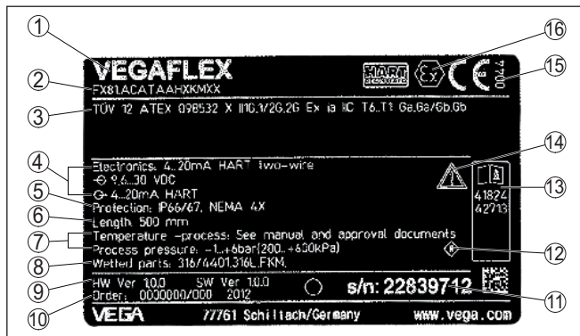
Рис. 1: Данные на типовом шильдике (пример)
