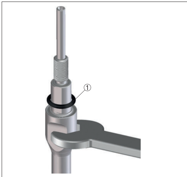
Рис. 40: Замена измерительного стержня
