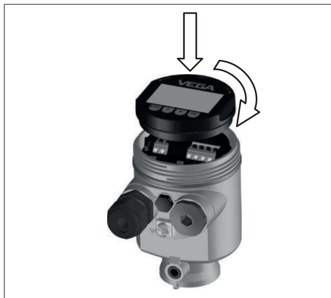
Рис. 7: Установка модуля индикации и настройки в отсеке электроники однокамерного корпуса
