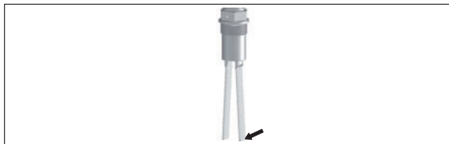
Рис. 29: Максимальная боковая нагрузка вдоль стороны вилки (к узкой стороне вилки)
