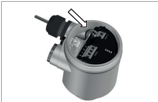
Рис. 12: Шаги подключения 5 и 6 - однокамерный корпус
