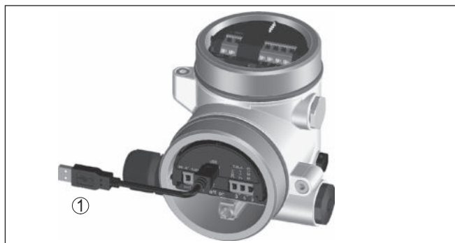
Рис. 21: Подключение ПК через USB к электронике Modbus 1 Кабель USB к ПК
