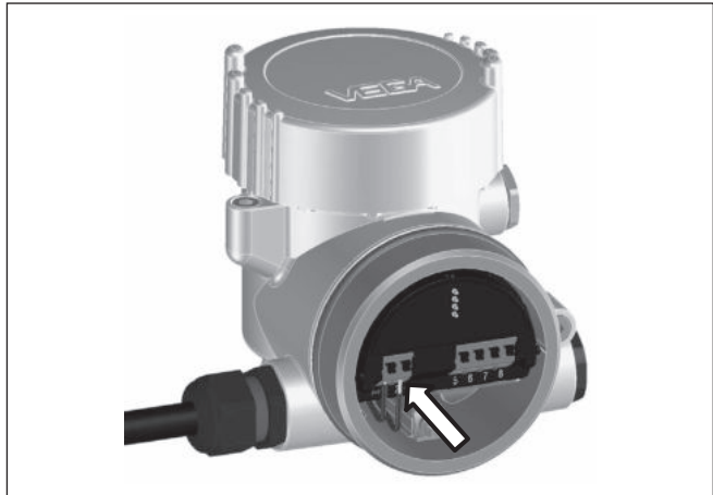
Рис. 30: Подключение: шаги 5 и 6
