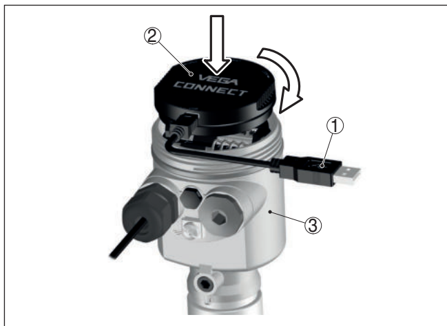
Рис. 21: Подключение ПК через интерфейсный адаптер прямо к датчику
