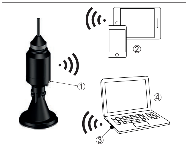
Рис. 3: Беспроводное соединение со стандартными устройствами для настройки
