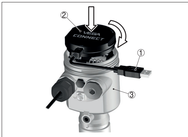
Рис. 37: Подключение ПК через интерфейсный адаптер прямо к датчику
